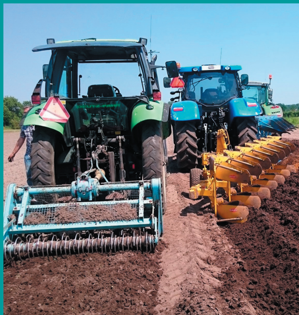
Testen van verschillende manieren van grondbewerking, van links naar rechts: spitten, ondiep ploegen, gewoon ploegen.
