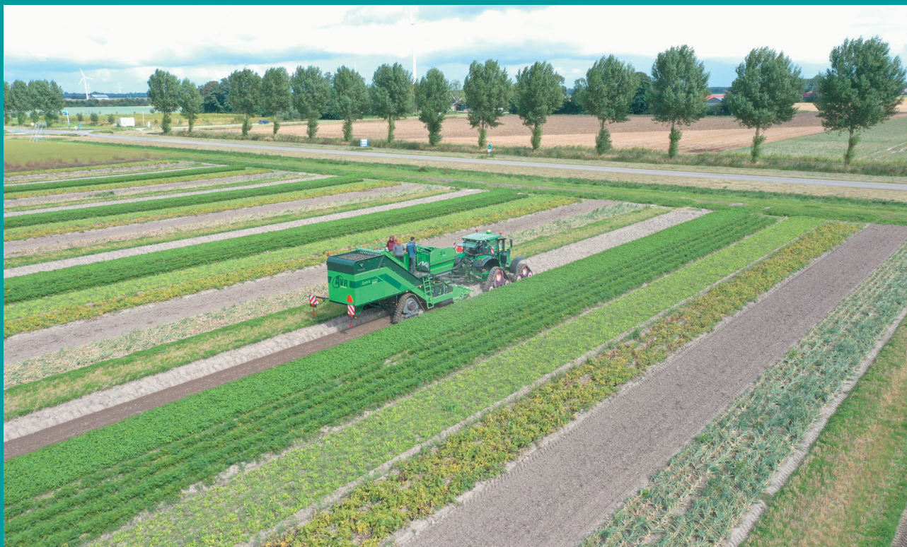
Aardappels rooien in strokenteelt op Fieldlab Boerderij van de Toekomst met een voor vaste rijpaden geschikte aardappelrooimachine.
