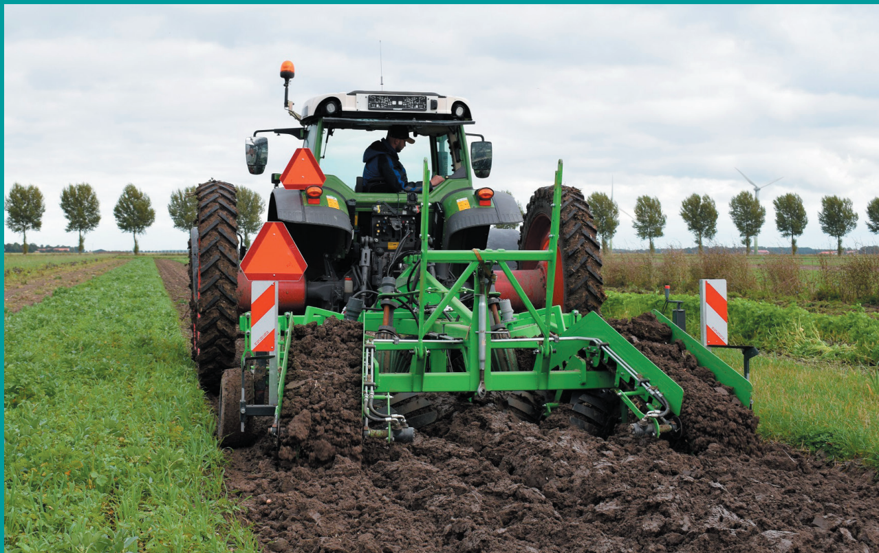
De voorloze ploeg, ontworpen om te kunnen ploegen in vaste rijpaden teelt en hierdoor tevens geschikt voor strokenteelt (foto: Mechaman).
