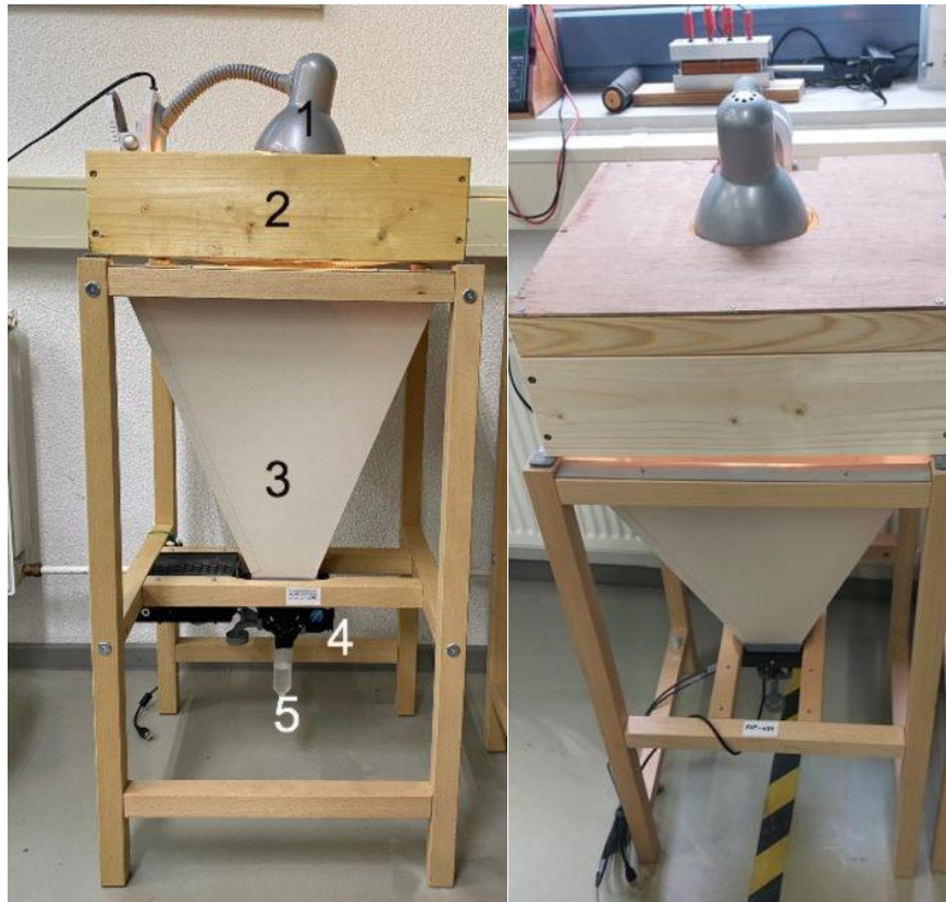
Figuur 1.19: Linker foto, Edapholog 1.0 met de verschillende onderdelen. 1: hittelamp, 2: bak met gaas, 3: kartonnen trechter, 4: blazertje, 5: opvangbuisje met iso-propanol. Rechterfoto, de Edapholog met afdekkap.
