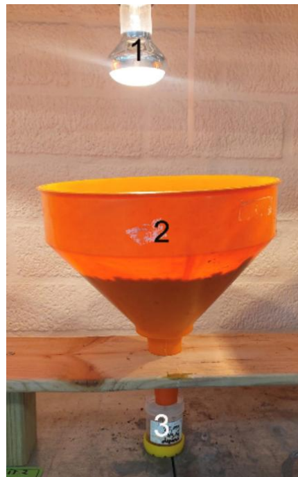
Figuur 1.24: Berlese-Tullgren opstelling bestaande uit 1: hittelamp, 2: trechter, 3: opvang potje met iso-propanol.
