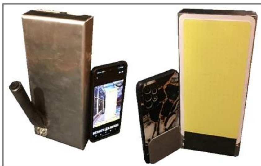
Figuur 1.2: De externe flits waarop een mobiele telefoon onder een hoek bevestigd werd. De achterzijde is links, de voorzijde is rechts getoond.
