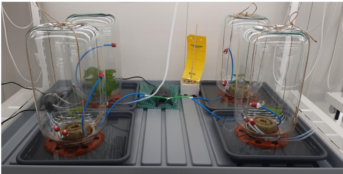
Figuur 3.1: testopstelling voor de detectie van ethyleen in verschillende behandelde planten.
