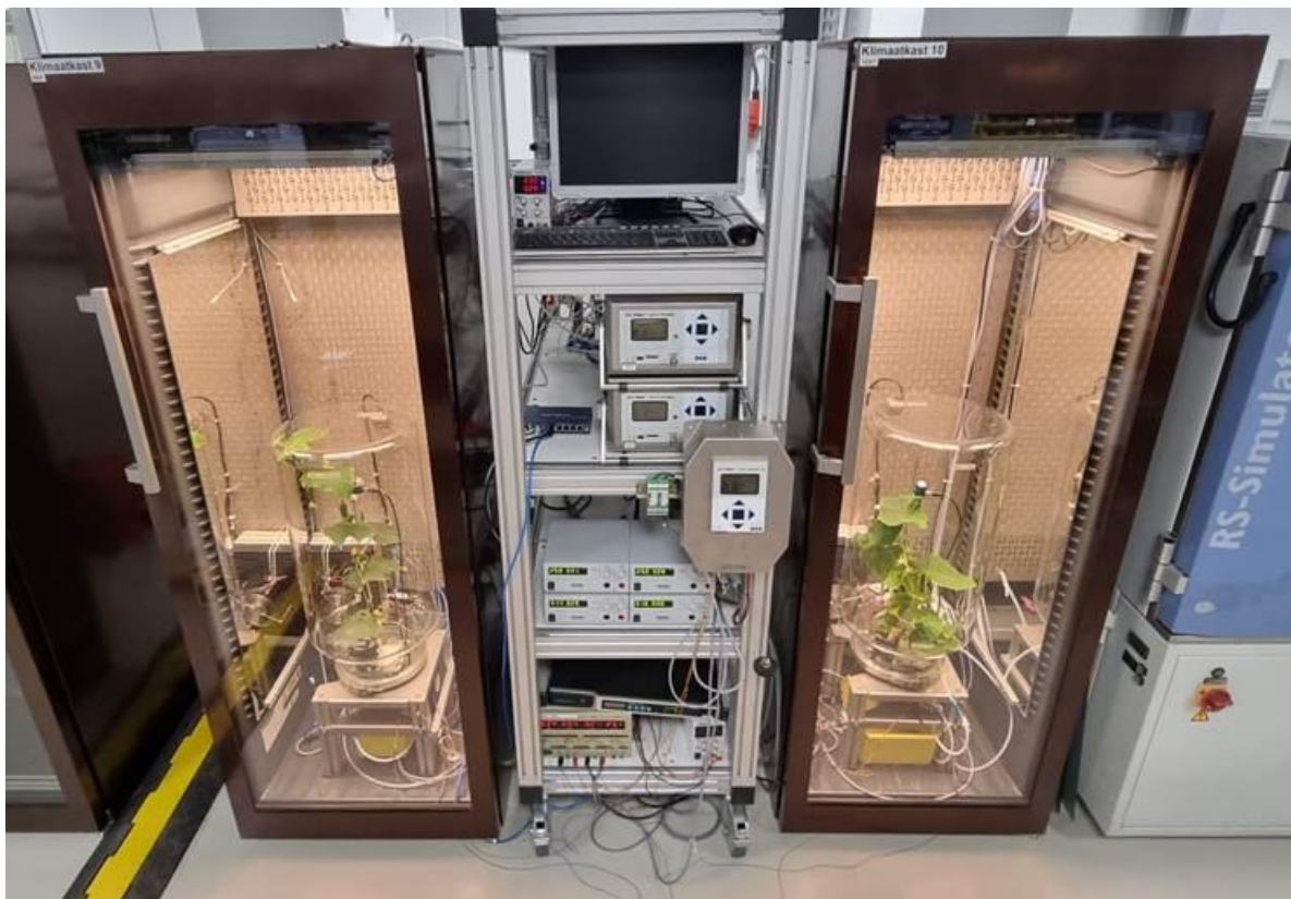
Figuur 3.2: Testopstelling met referentie- en testplanten, hier met komkommer.
